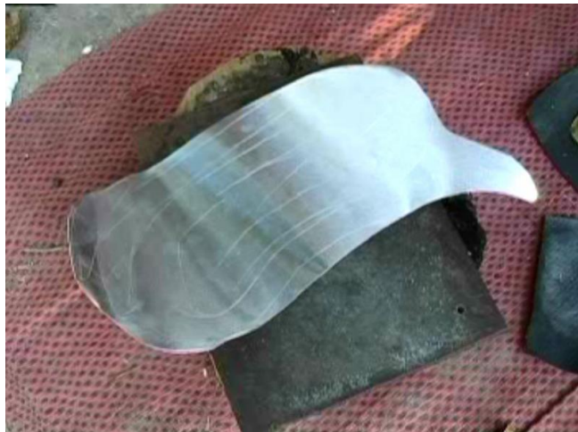
ขั้นที่ 1 ตัดแผ่นนิเกิลหรือแผ่นอลูมิเนียม ให้มีขนาดพอเหมาะที่จะใช้
