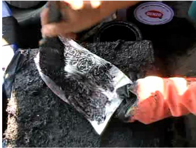
ขั้นที่ 4 ทาสีน้ำมัน (สีดำ) ลงบนแผ่นนิเกิล ที่ต้องละลายแล้ว
